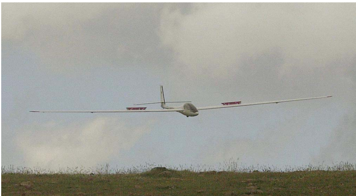
Figure 37. L'Orcal est un planeur "style F3i" mais ses AF à lames sont très bien adaptés aux conditions difficiles de l'atterro à la Borne 504.
