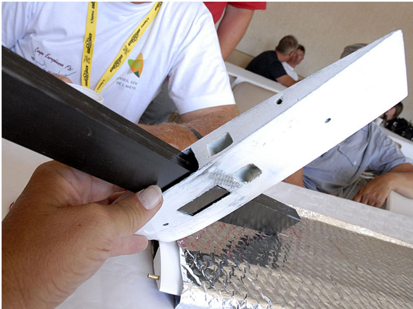
Photo 34. La pièce jointive inventée par Jean Chenoz qui permet de visser une paire d'ailes VzMax sur un fuselage de RAC ou de JCH.
