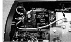
Danach das Adapterkabel mit der Servosteckerseite in das Modul einstecken, das Minuskabel (schwarz) muss hierbei nach oben zeigen. Nun den Platinenstecker auf die Trainerbuchse stecken. Spannungsversorgungskabel sauber nach unten führen. Der Anschluß des Akkus ist bereits auf der vorherigen Seite beschrieben und erfolgt nach dem gleichen Prin-
