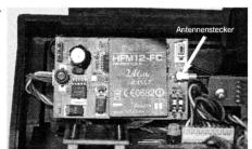
Modul mit einem der mitgelieferten Klebepads auf die Modulplatte kleben. Das Antennenkabel in die Antennenbuchse einstecken. Achten Sie darauf, daß der Stecker dabei nicht beschädigt wird!
