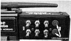
Die LED-Halterungen von vorne einsetzen. LED's in die LED-Halterungen stecken, dabei einen kleinen Schraubendreher verwenden.
