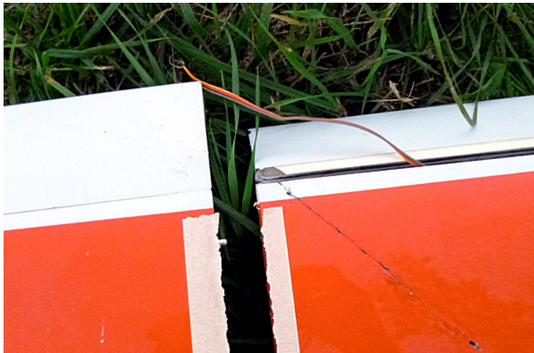
Figure 8. L'extrémité droite du panneau central. On distingue la découpe du câble de remorquage et le fil du servo qui est venu coincer le stab.
